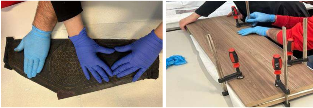
Resim 39-40. Yapıştırma işlemi tamamlanan derinin pres altına koyulması
