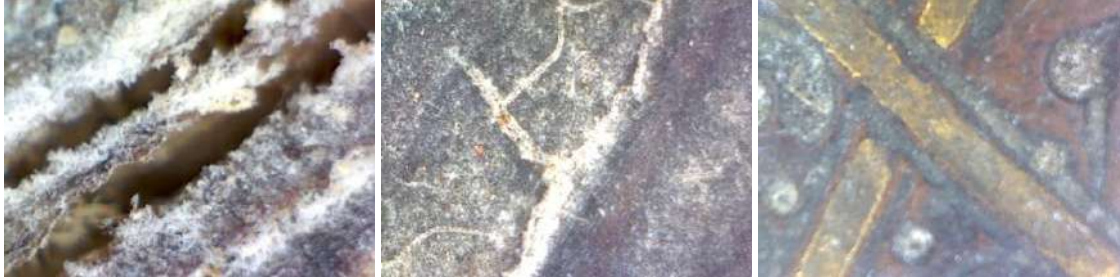
Resim 7-8-9. Yüzeyde oluşan bozulmaların mikroskop görüntüleri
