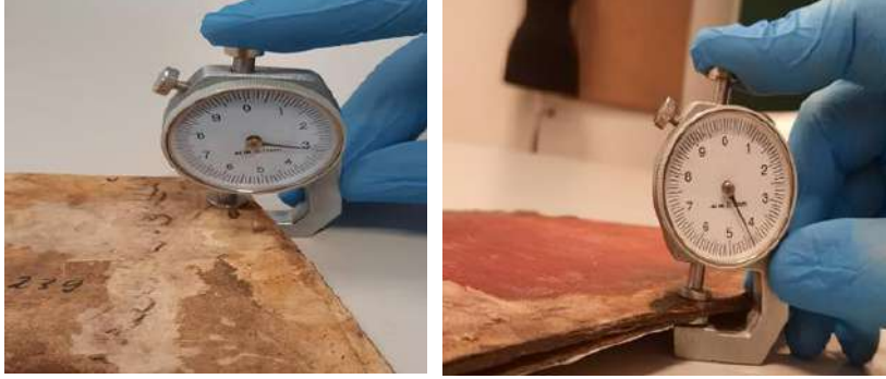
Resim 24-25. Mukavvanın kenar kalınlıklarının hassas kumpas ile ölçümünün yapılması
