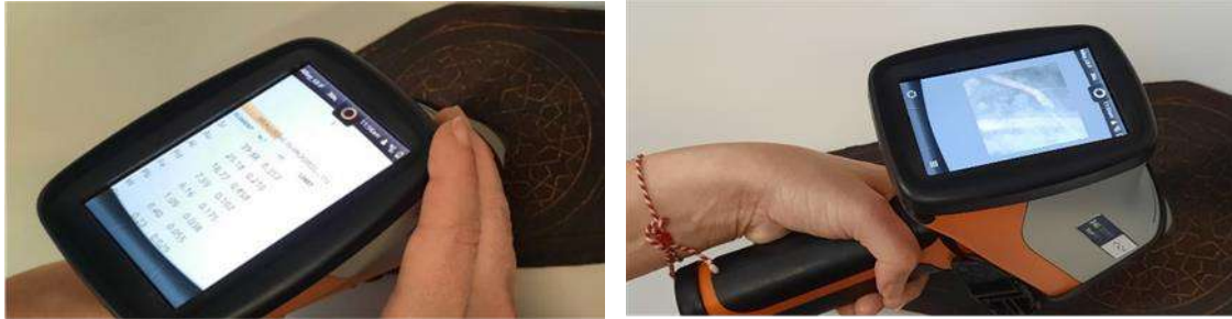
Resim 13-14. XRF ile deri yüzeyde ölçüm yapılması
